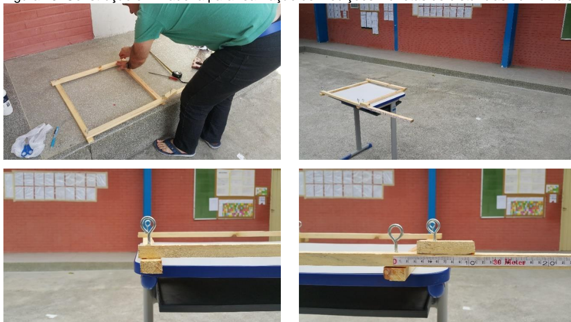
Figura 13: Construção em madeira para realização de medições indiretas de distâncias horizontais.
